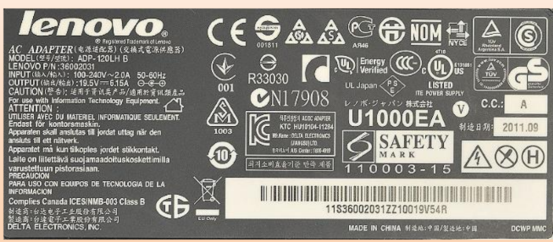
120W 19.5V AC Adapter (入力:110-240V、2.0A 50-60Hz 出力: 19.5V 6.15A) x1
